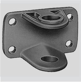
Abschleppkupplungen sind nicht bauartgenehmigungspflichtig (§22 a StVZO). Der Verwendungszweck ist auf das Abschleppen von betriebsunfähigen Fahrzeugen und in Ausnahmefällen auf Rangierzwecke beschränkt. Die Verwendung für den Anhängerbetrieb ist nicht gestattet.
